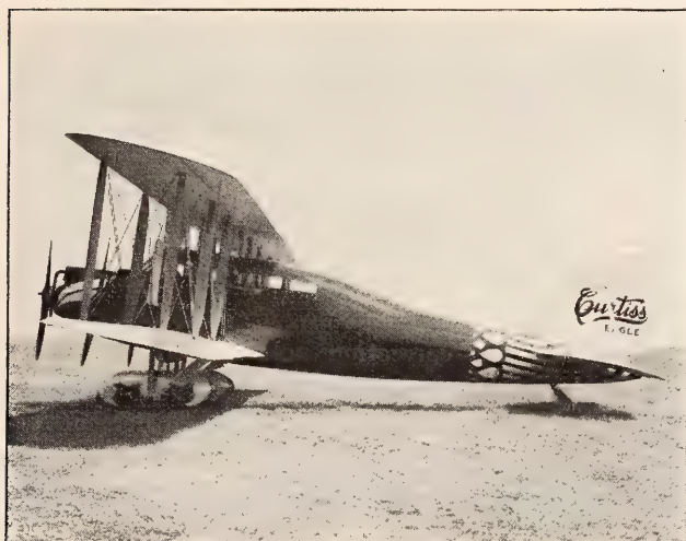
Le Curtiss-Eagle, avion tri-moteur 450 HP, limousine à 8 places.
