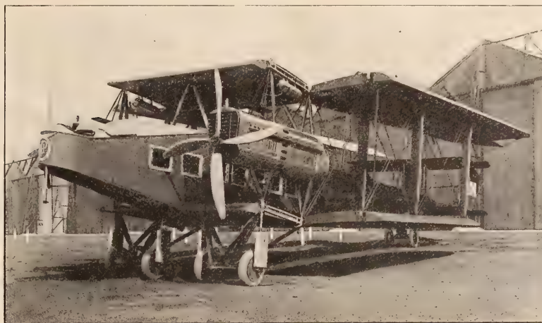
Avion HANDLEY-PAGE, type O-7, ailes repliées. 15 passagers dans la cabine-salon, 2 passagers en avant du pilote et du mécanicien.
