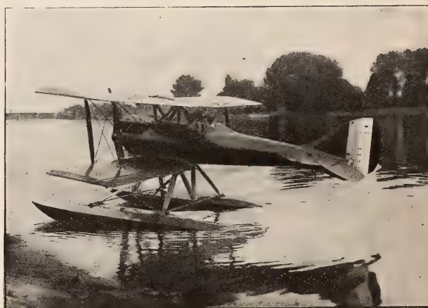
Hydravion rapide NIEUPORT à flotteurs dérivé du Nieuport terrestre type 29.
