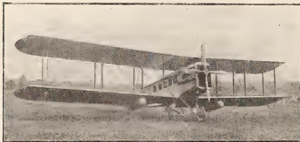
La limousine WESTLAND à moteur NAPIER 450 HP, employée sur Paris-Londres par la Air Post of Banks Ltd.
