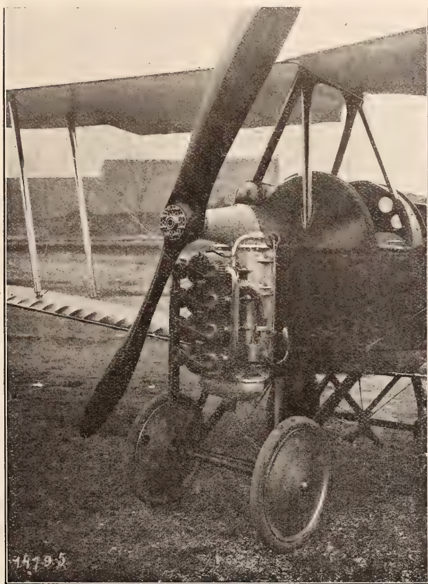
Le moteur 50 HP Henri Potez, système Potez-Coroller.
