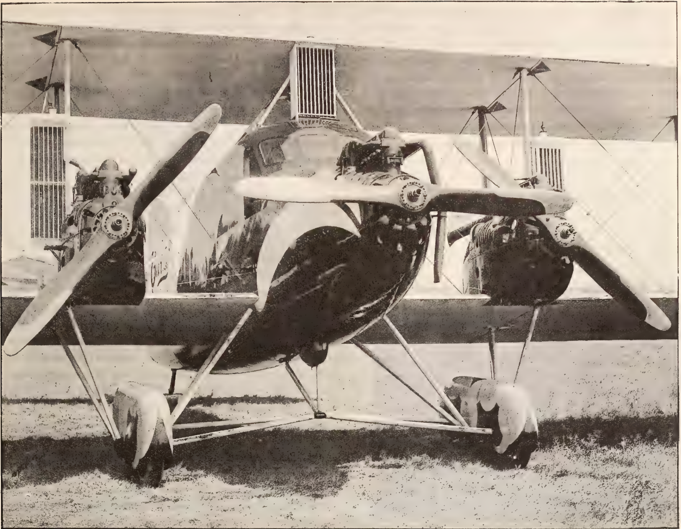
Les trois moteurs CURTISS K-6 150 HP du premier CURTISS-EAGLE. Le carénage articulé des doubles roues, soutenu par les V du train d'atterrissage, est très visible.
