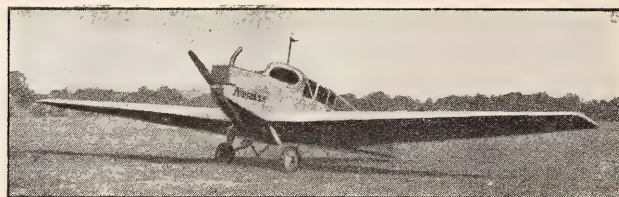
Le monoplan métallique Junker (Moteur B. M. W. 185 HP.).
