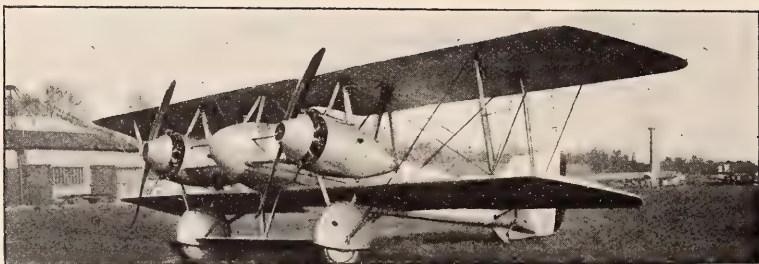
Le biplace bimoteur blindé LIORÉ ET OLIVIER. Équipé de moteurs rotatifs Rhône 175 HP.
