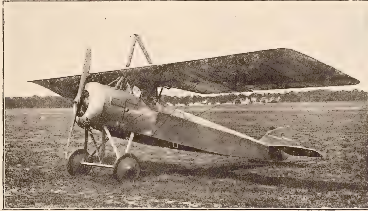
Parasol MORANE-SAULNIER 50 HP Rhône. Biplane-école à double commande.
