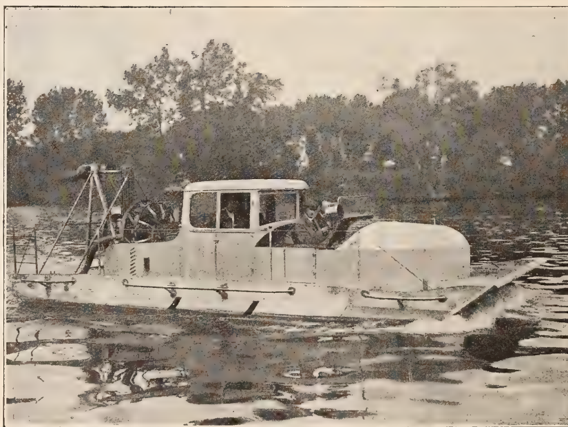
L'hydroglisseur de LAMBERT, type XI, moteur SALMSON Z-9, 230 HP. Carrossé en coupé de luxe pour la Compagnie du Canal de Suez. Au volant, M. le comte de Lambert.
